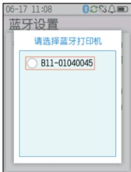
5、稍等片刻，待设备连接上打印机即可使用蓝牙打印功能。
