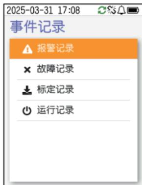
在事件列表通过短按确认键（OK）翻页，左右键移动选中的条目，长按确认键（OK）呼出快捷菜单可以查看记录详情和跳转到指定的记录条目。见下图：
