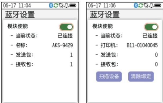
在主菜单->高级菜单->功能开关中关闭“打印机支持”时，设备蓝牙作为从站可连接APP（上左图）；打开“打印机支持”时，设备蓝牙作为主站可连接蓝牙打印机打印检测结果（上右图）。
